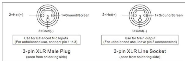
**Входные/выходные разъёмы XLR: 1 — (Экран/Земля), 2 - (+ сигнала), 3 - (- сигнала)**
